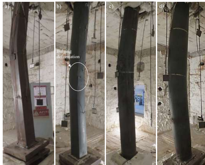
Figure 2: Interior of the furnace chamber: (a) SR-CFST-S-TML1, (b) SR-CFST-S-TML2, (c) SR-CFST-C-TML1, (d) SR-CFST-C-TML2
